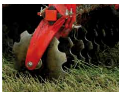
Agresívny tvar a poloha kotúčov zaručujú veľmi dobré zarezávanie a dokonalé zmiešavanie
