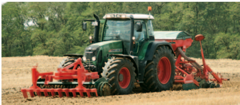
Multifunkčné nasadenie: Priprava pôdy pomocou čelného valca VN-Terrapak a súčasný výsev sejačkou VN MasterDrill A
