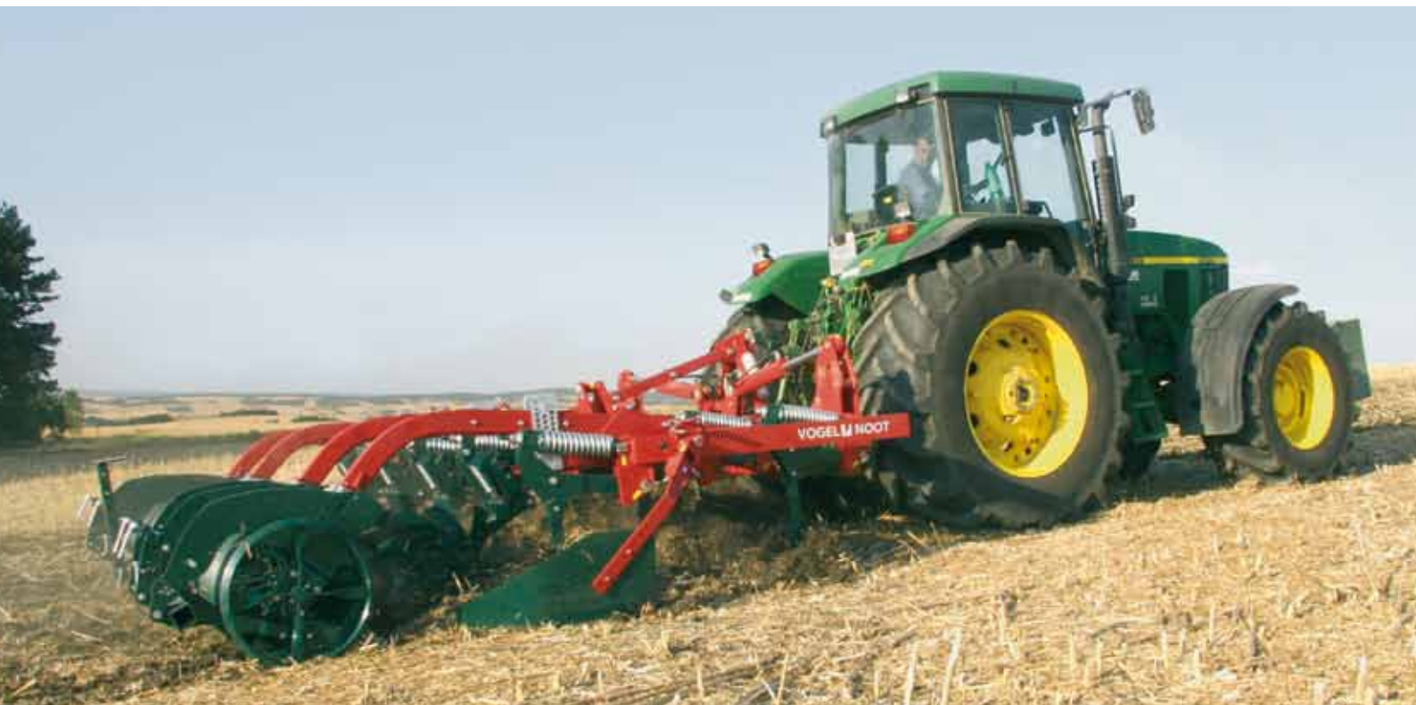
TerraFlex 400 výklopný so zabezpečením NonStop s dodatočnou pružinou a valcom Terrapak
